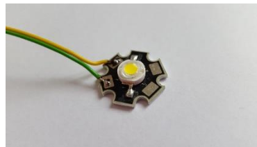
Obr.7 – výkonová LE Dioda s chladičem
