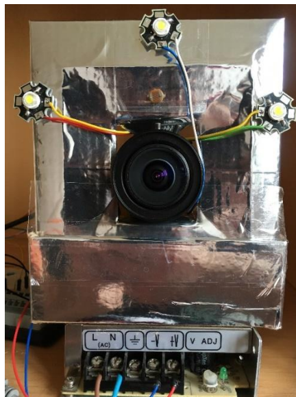
Obr.11 – držák objektivu s odraznou plochou a zdrojem napětí pro LE Diody
