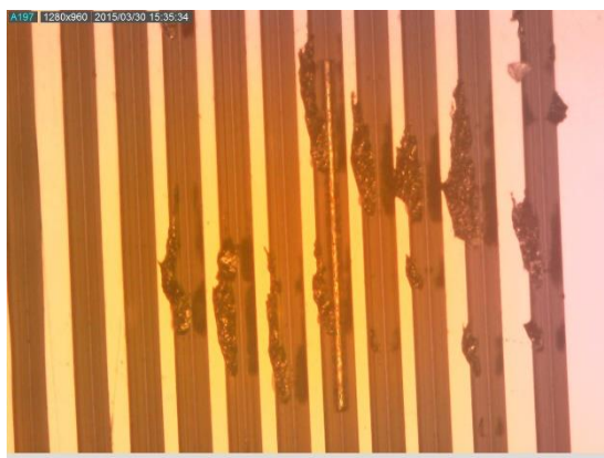
Obr.4 – mikroskopický snímek nedolisů
