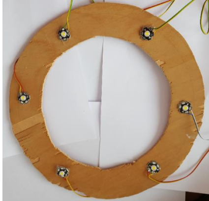
Obr.10 – dřevěné mezikruží s LE Diodami
